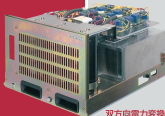
双方向電力変換ユニット(予備器)
